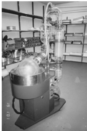
Distillazione. Vaporizzatore rotativo che può essere utilizzato per la fabbricazione di olio di hascisc.
