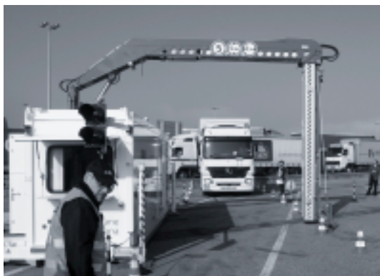
Scanner pour camions. Le scanner mobile pour camions permet d'effectuer les contrôles douaniers de manière rapide et efficace.
