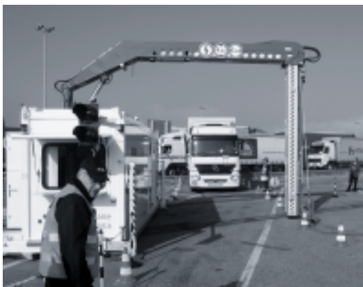
Scanner per autocarri. Lo scanner mobile per gli autocarri permette di effettuare i controlli doganali in modo veloce ed efficace.
