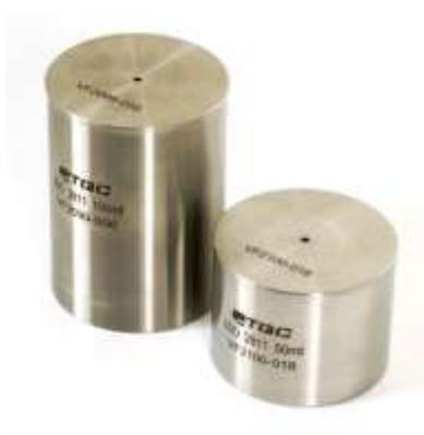
4.2 L'introduction du produit s'effectue de préférence à l'aide d'une spatule. Le couvercle et la face externe du récipient doivent demeurer propres. Lors de l'apposition du couvercle et éventuellement de la sortie du produit à travers l'ouverture, il faut en particulier veiller à ce que la face extérieure du couvercle soit nettoyée.
