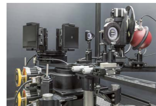
La stazione di misurazione per le misurazioni della brillantezza è pronta per misurare un campione lucido.
