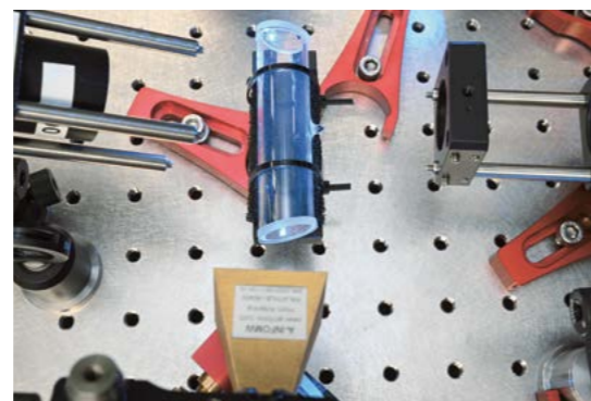
Cella a vapore alcalina (tubicino blu, al centro) per gli atomi di Rydberg. In basso nell'immagine si trova l'antenna a tromba color oro per i campi elettrici.
