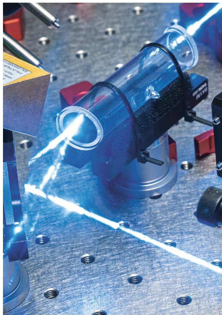
Immagine di copertina: cella a vapore alcalina (tubicino blu) per atomi di Rydberg con raggi laser resi visibili (cfr. contributo pag. 16–17).
