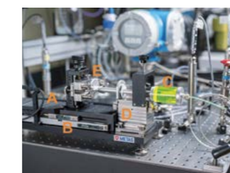
Fig. 1: Sistema a pistoni dell'impianto Microflow del METAS: (A) tavolo lineare di alta precisione, (B) sistema di misurazione lineare, (C) pistone, (D)+(E) montaggio e posizionamento del pistone.
