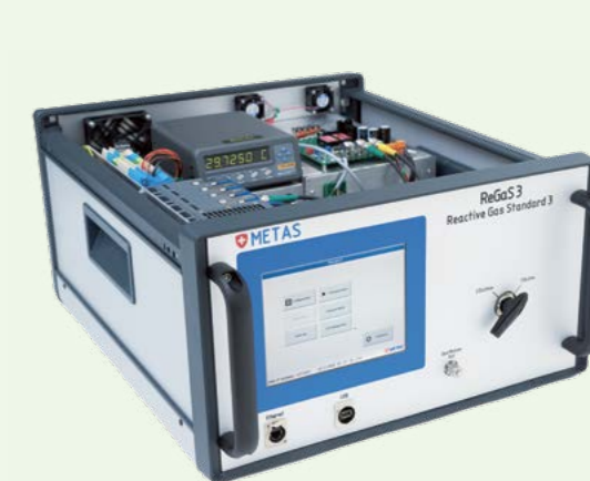
Generatore di gas (ReGaS3) per la produzione di miscele di gas di riferimento.
